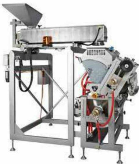
Der WRM Mischer mischt die Trockenstoffe mit dem Binder, anschließend geht die Masse in den WRF Walzenformer.
