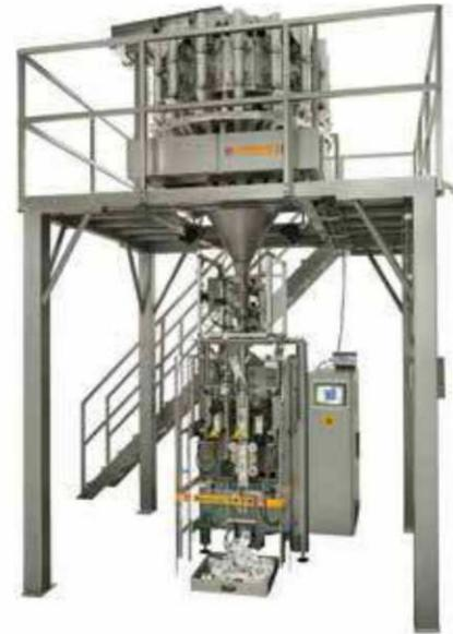
Kombinationswaage CP-16-S32 in Kombination mit der Schlauchbeutelmaschine RM-270.
