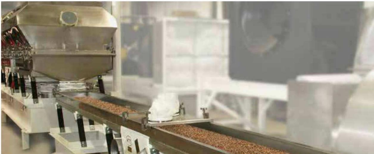
Bei den Prozessanlagen von Witte umschließt die Förderoberfläche aus Edelstahl die Trockenzone. Das schützt das Produkt vor Verunreinigungen.
