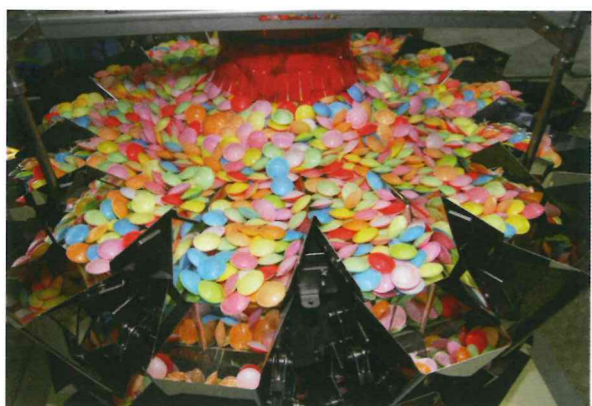
Mit einer Leistung von 100 bis 140 Takten pro Minute verwiegt die innovative Mehrkopfwaage ALPHA Advance z. B. bruchempfindliche und anhaftende Produkte.
